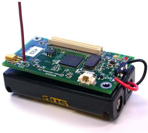
**Figura 2.5:** Nodo sensore MICA2
