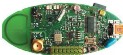
**Figura 2.8:** Nodo sensore EyesIFX
