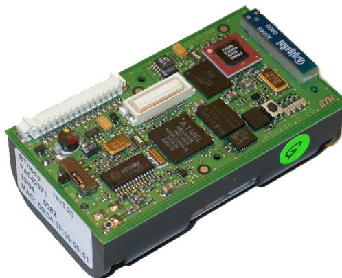
**Figura 2.7:** Nodo sensore BTNode
