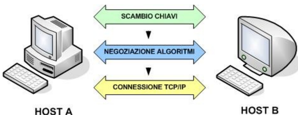
Figura 9 - SSH - Instaurazione connessione
