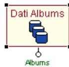
Figure 3.4: Esempio di Multi-Data Unit
